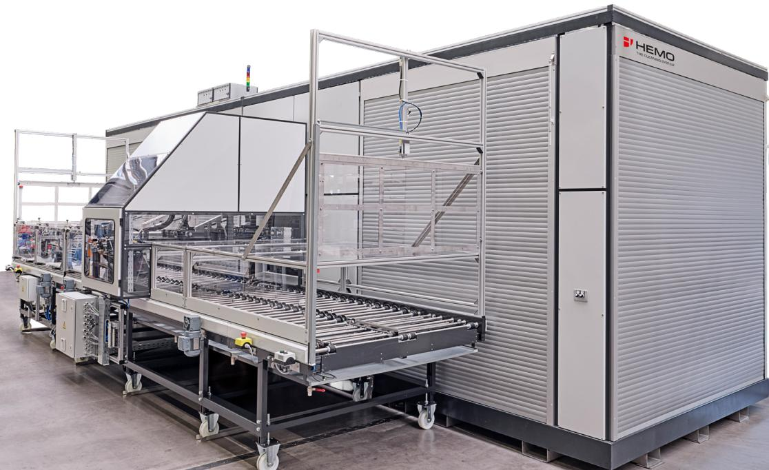
Was Andreas Fritz damit meint, zeigt sich beim Blick auf die beeindruckende Anlage vom Typ HYBRID PVD, die mitten in der PVD-Beschichtung des Herstellers installiert ist. Mit den Dimensionen 10.000 x 4.900 x 3.450 mm (LxBxH) inkl. Beschickung fällt die Teillereinigungsanlage mit den zwei lösemittelhaltigen und fünf wässrigen Reinigungsstufen zwar vergleichsweise kompakt aus, dennoch musste sie für die Integration unter begrenzten Raumverhältnissen zweiteilig ausgeführt werden.
