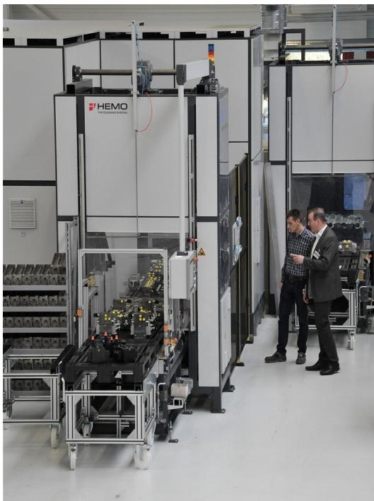
„ Die Hydraulikblöcke fahren in beliebiger Anordnung auf Kunststoff-Europaletten in die Anlage. Um maximalen Output zu gewährleisten, können bei Bedarf zwei Paletten übereinander angeordnet werden. In dieser Konfiguration lassen sich bis zu drei Tonnen Reinigungsgut stündlich in bester Qualität reinigen, was die überlegene Leistungsfähigkeit unserer Anlagentechnik unterstreicht. “
