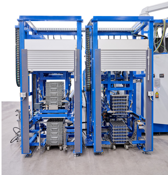
Rechts im Bild die Aufgabestation, links daneben findet die Teileentnahme statt. An beiden Stationen kommen Rollwagen zum Einsatz.
