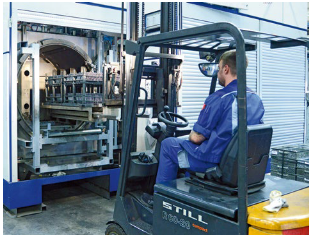
Die Anlage kann sowohl von der Vorderseite mit dem Gabelstapler als auch von der Rückseite vollautomatisch beladen werden.
