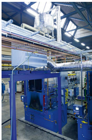
Die Abwärme der Härtereiofen wird für die Wärmerückgewinnung genutzt.
