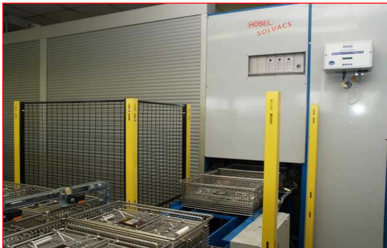
SOLVACS-Durchlaufanlage für die Reinigung und Konservierung von Präzisionsdrehteilen mit CKW
